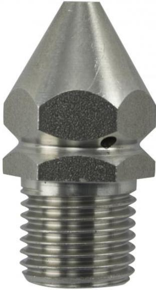
Ce gicleur HP en acier inoxydable est conçu pour le débouchage efficace des canalisations d'un diamètre compris entre 50 et 200 mm. Son jet frontal puissant cible directement les obstructions, tandis que ses trois jets propulseurs favorisent l'avancement du flexible sur lequel il est monté.
