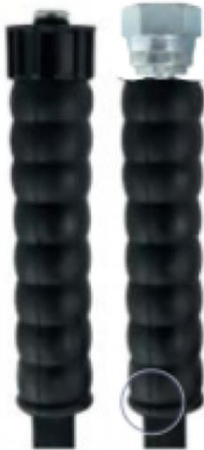
Flexible HP noir 2 tresses acier équipé avec deux raccords à visser. Le flexible noir est plus résistant aux corps gras de type minéral. Le flexible noir présente l'avantage de la souplesse et il est donc moins fragile à l'écrasement. Le principe des raccords démontables manuellement évite l'emploi d'outils.
