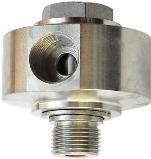
Ce raccord HP rotatif 360°est idéal pour équiper les enrouleurs automatique et les potences de lavage véhicules. Ce raccord HP rotatif 360°est équipé de roulements étanches monté avec de la graisse silicone. Il permet une rotation très souple même sous pression lors de l'utilisation.
