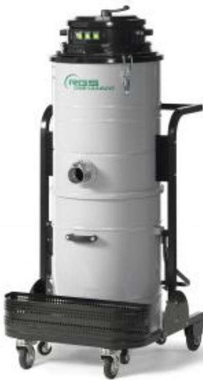
L'**aspirateur ONE 103 ECO** est capable d'aspirer en même temps des poussières, des solides et des liquides sans retirer le système de filtration.
