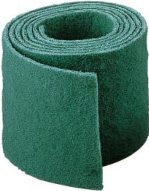
Ce rouleau vert de nettoyage et de **récurage multi-usage** en fibres synthétiques de **haute qualité** est constitué d'une nappe non tissée à structure ouverte imprégnée d'une résine résistante contenant des particules abrasives réparties de façon homogène.
